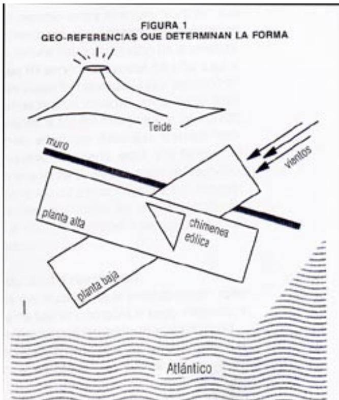
Si el cuerpo del rectángulo primario -el muro y la planta alta- mira al Teide y al mar, el alma del mismo -la "gran chimenea" triangular y la planta baja- acogen al viento mirando al noreste. Con dos rectángulos cruzados, un muro y una chimenea se responde a esa geografía.
